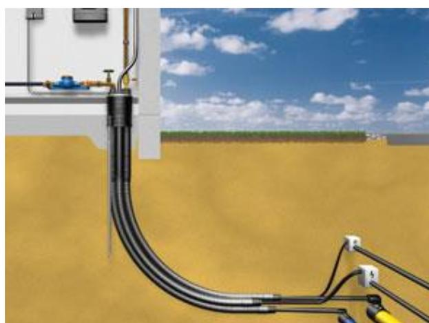
Gebäude ohne Keller werden nach dem heutigen Stand der Technik am besten durch eine Mehrsparten-Hauseinführung versorgt. Dieses bedeutet, dass Strom, Gas, Wasser und Telekommunikation platzsparend und wasserdicht durch die Bodenplatte geführt werden. Hierbei wird das Rohbauteil (runde oder eckige Ausführung) getrennt vom Installationsteil in die Bodenplatte eingegossen.
